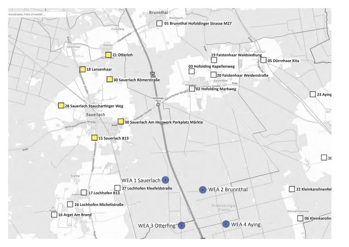
Visualisierung geplanter Windenergieanlagen Hofoldinger Forst HOF28 **Sauerlach Stauchartinger Weg** 696751 E, 5317113 N, 620 m üNN . 24.2.2021, 16:23 . Nikon D610, 50 mm 4 Windenergieanlagen (WEA). Rotordurchmesser 170 m, Nabenhöhe 165 m, Gesamthöhe 250 m WEA 2: 643 m üNN WEA 1: 636 m üNN WEA 4: 646 m üNN WEA 3: 658 m üNN 6.152 m 4.790 m 7.542 m 6.302 m
